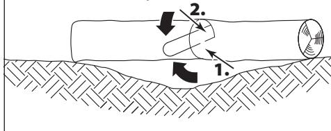
Ha a fatörzs valamelyen talajmelyedés felett van a két végén megtámasztva (lásd a fenti ábrát), akkor először alulról fűrészjen az átmérő 1/3-ig, majd felülről fűrészje át.
