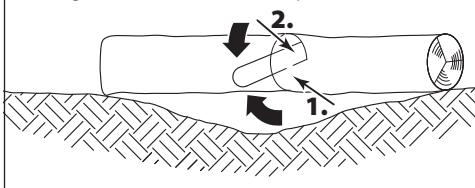
Se il tronco giace su una depressione del terreno sostenuto sulle estremità, come mostrato nella figura, tagliare prima 1/3 del diametro del tronco da lato inferiore, poi il resto dall'alto fino all'altezza del taglio inferiore.
