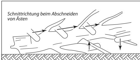
Damit versteht man das Trennen der Äste vom gefallenen Baum. Lassen Sie beim Abschneiden von Ästen zuerst die größeren Äste, die den Baum stützen, an. Trennen Sie kleinere Äste mit einem Schnitt ab. Äste, die gespannt sind, sollten von unten nach oben abgeschnitten werden, damit es nicht zu einer Verklemmung der Säge kommt.
