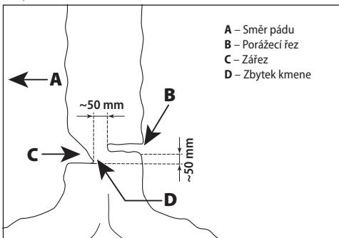
Vyřízněte v pravém úhlu ke směru pásu stromu zářez hloubky 1/3 průměru stromu. Nejprve provedte vodorovný řez. Tím se zabrání zaseknutí pily nebo vodící lišty při nasazení druhého řezu.
