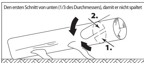
Wenn der Stamm auf einem Ende aufliegt, so wie es im Bild gezeigt wird, schneiden Sie zuerst das 1/3 des Stammdurchmessers von unten ein, danach den Rest von oben auf die Höhe des unteren Schnitts.
