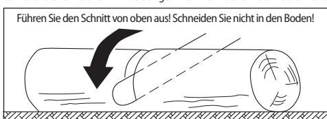
Schneiden Sie von oben, wenn die ganze Länge des Stamms gleichmäßig unterlegt ist, so wie es auf dem Bild gezeigt wird.
