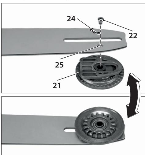
❑ Das Kettenspannwerk (21) auf die (5) Führungsliste von außen so anbringen, dass der Führungsbolzen des Kettenspannwerks in das Oberspannloch der Führungsliste (24) eingeführt wird. Von der Unterseite durch das Unterspannloch der Führungsliste (25) das Kettenspannwerk mit Hilfe der Schraube des Kettenspannwerks (22) befestigen.
