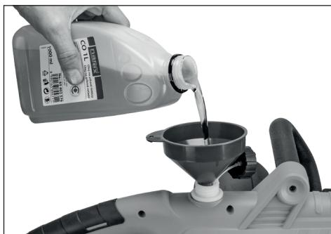
**Figyelem! Kérjük, hogy csak lánccfurésekhez használatos, biológiai úton 100%-ban lebomló természetes olajt töltson a lánccfurész felett.**
