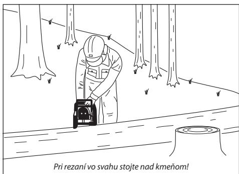
Pri rezaní vo svahu vždy stojte nad kmeňom smerom do svahu, ako znázorňuje obrázok. Aby ste v momente „perezania“ mali plnú kontrolu, znižte na konci rezu prítlak, bez toho aby ste uvoľnili pevné zovretie držadiel pily. **Pozor, aby sa retáz nedotykal zeme!** Po ukončení rezu počkajte na zastavenie retaze, pred tým než pilu vytiahnete.
