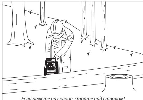
Если режете на склоне, всегда стойте над деревом, в сторону склона – см. рисунок. Чтобы вы в момент «прореза» имели полный контроль над прибором, занесите к концу резки прижим, не ослабляя жесткий захват рукоятки пилы. **Осторожно, цепь не должна касаться земли!** После окончания резки подождите, пока цепь не остановится и только потом пильу выньте.
