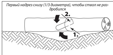
Если ствол лежит над впадиной, подпротивлен на концах, как указано на рисунке, выполните сперва надрез до одной трети диаметра ствола с нижней стороны и потом остаток сверху на высоту нижнего надреза.
