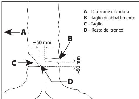
Con un angolo retto in direzione della fascia dell'albero creare un intaglio profondo circa 1/3 del diametro dell'albero. Innanzitutto eseguire un taglio orizzontale. In questo modo si evita che la sega o la barra guida si bloccino quando si va ad eseguire il secondo taglio.
