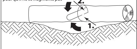
Si le tronc est placé ainsi qu'ilustré sur deux extrémités sur un fossé dans le terrain, coupez d'abord l'entaille d'abattage à une profondeur correspondant à 1/3 du diamètre de l'arbre en commençant par le bas, puis amorcez la coupe d'abattage plus haut à la hauteur de l'entaille inférieure.
