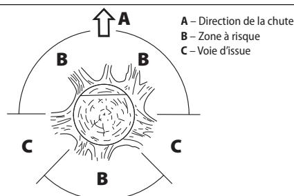
Avant la coupe de l'arbre, une voie d'issue doit être planifiée et, si besoin est, dégagée. La voie d'issue devrait aller en biais de la ligne de chute de l'arbre abattu, comme le montre l'illustration.
