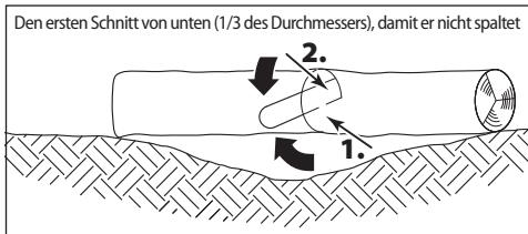
Wenn der Stamm über eine Geländevertiefung mit Stützung auf beiden Enden aufliegt, so wie es im Bild gezeigt wird, schneiden Sie zuerst das 1/3 des Stammdurchmessers von unten ein, danach den Rest von oben auf die Höhe des unteren Schnitts.
