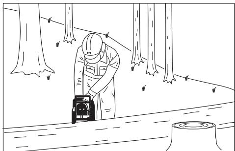
Lors des travaux de coupe en pente, tenez-vous toujours au-dessus du tronc, comme illustré. Afin d'assurer le contrôle complet au moment où le tronc est « complètement scié », réduisez la pression appliquée en fin de coupe tout en continuant à maintenir une prise ferme sur les poignées de la tronçonneuse. **Attention à ce que la chaîne n'entre pas en contact avec la terre !** Une fois la coupe terminée, attendez l'arrêt total de la chaîne de la scie avant de retirer la tronçonneuse.
