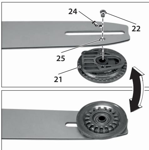
❑ Расположите механизм натяжения цепи (21) на направляющей шине (5) с ее внешней стороны так, чтобы направляющий штифт механизма натяжения цепи вошел в верхнее крепежное отверстие направляющей шины (24). Затем с нижней стороны через нижнее крепежное отверстие направляющей шины (25) с помощью винта механизма натяжения цепи (22) закрепите механизм натяжения цепи.
