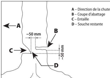
Coupez d'abord une entaille en angle droit à une profondeur correspondant à 1/3 du diamètre de l'arbre. Effectuez tout d'abord une coupe horizontale. Vous évitez ainsi un blocage de la tronçonneuse ou du guide-chaîne lors de la coupe de la deuxième entaille.
