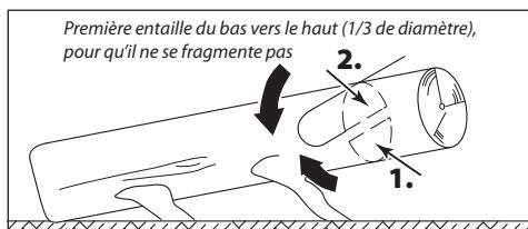
Si le tronc est placé ainsi qu'ilustré sur une extrémité, coupez d'abord l'entaille d'abattage à une profondeur correspondant à 1/3 du diamètre de l'arbre en commençant par le bas, puis amorcez la coupe d'abattage plus haut à la hauteur de l'entaille inférieure.
