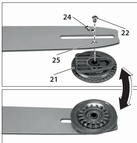
❑ Coloque el sistema tensor de cadena (21) sobre la espada (5) desde su lado exterior, de tal manera que el pivote del sistema tensor entre en el agujero superior de la espada (24). A continuación, asegure el sistema tensor de la cadena a través del agujero inferior de la espada (25) mediante el tornillo del sistema tensor de cadena (22).
