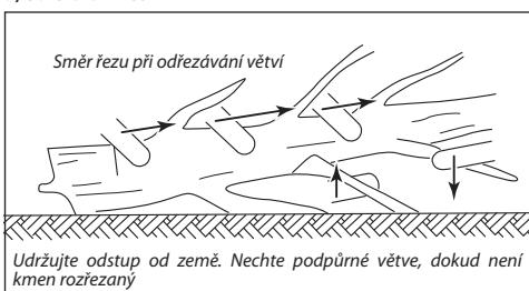
Tímto se rozumí oddělení větví od poraženého stromu. Při odrezávání větví ponechejte nejdříve větší větve, které strom podepírají. Menší větve, oddělte jedním řezem. Větve, kterou jsou napnuté, by měly být odrezávány odspodu nahoru, aby se zabránilo sevření pily.
