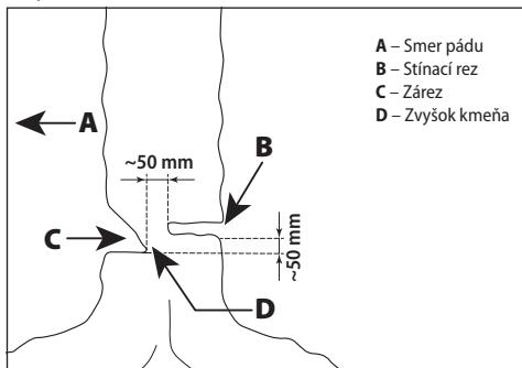
Vyrežte v pravom uhle ku smeru pásu stromu zárez hlboký 1/3 priemeru stromu. Najprv urobte vodorovný rez. Tým sa zabráni zaseknutiu pily alebo vodiaci listy pri nasadení druhého rezu.
