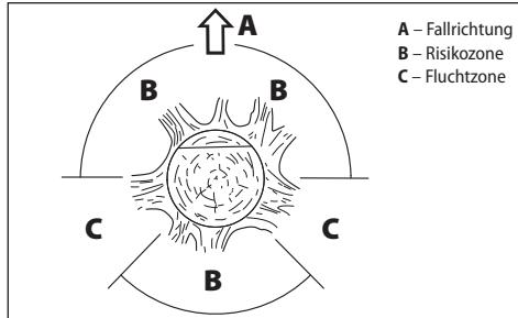
Vor dem Fällen sollte ein Fluchtweg geplant und bei Bedarf ausgeräumt werden. Der Fluchtweg sollte schräg von der erwarteten Linie des gefällten Baums führen, so wie es auf dem Bild ersichtlich ist.
