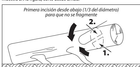
Si el tronco se apoya EN un extremo, como se muestra EN la imagen, primero haga una muesca de 1/3 del diámetro del tronco por abajo, luego el resto desde arriba, a la altura de la muesca inferior.
