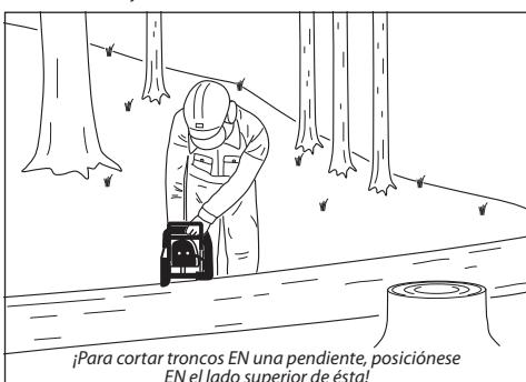
Al cortar troncos EN una pendiente, siempre hágalo posicionándose EN el lado superior de la pendiente, como se muestra EN la figura. Para tener pleno control al finalizar el corte, disminuya la presión EN el extremo de la incisión sin soltar firmemente las empuñaduras de la motosierra. ¡Asegúrese de que la cadena no toque el suelo! Terminado el corte, espere a que se detenga la cadena, antes de extraer la motosierra.
