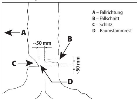
Schneiden Sie im Rechtwinkel zur Richtung des Baumbandes einen Schlitz bis zu einer Tiefe von 1/3 des Baumdurchmessers ein. Führen Sie zuerst den waagerechten Schnitt durch. Damit wird die Verklemmung der Säge oder der Führungsschiene beim Ansetzen des zweiten Schnitts vermieden.
