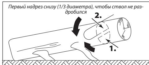
Если ствол лежит одной стороной на земле и противоположная сторона приподнята, как указано на рисунке, выполните сперва надрез до одной трети диаметра ствола с нижней стороны и потом остаток сверху на высоту нижнего надреза.
