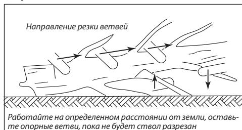
Под этим подразумеваем отсоединение ветвей от срубленного дерева. При отрезке ветвей оставьте большие ветви, оказывающие поддержку дереву. Малые ветви отрежьте одним ходом. Гибкие ветви следует резать снизу вверх, чтобы предотвратить сжатие пилы.
