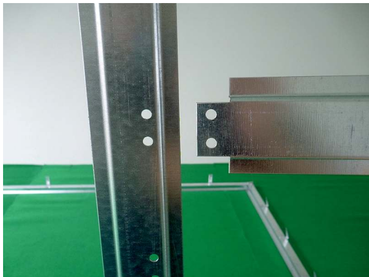
Montáž čelní příčky (pravé) k čelnímu pantovému sloupku (poz. 72 a 11)
