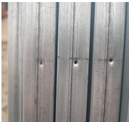
obr. 9 - připravené otvory na šrouby
