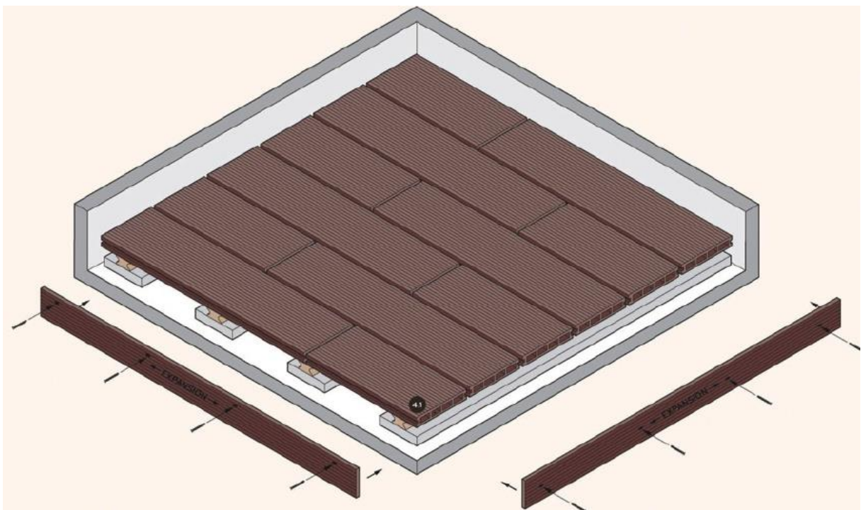
Obr. 9 – pokládka WPC desek
